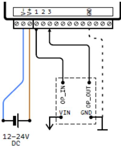
Typischer Anschluss für eine Steuerung mittels Dauersignal (optional konfigurierbar) für den Betrieb (CH1, aktiv high).
