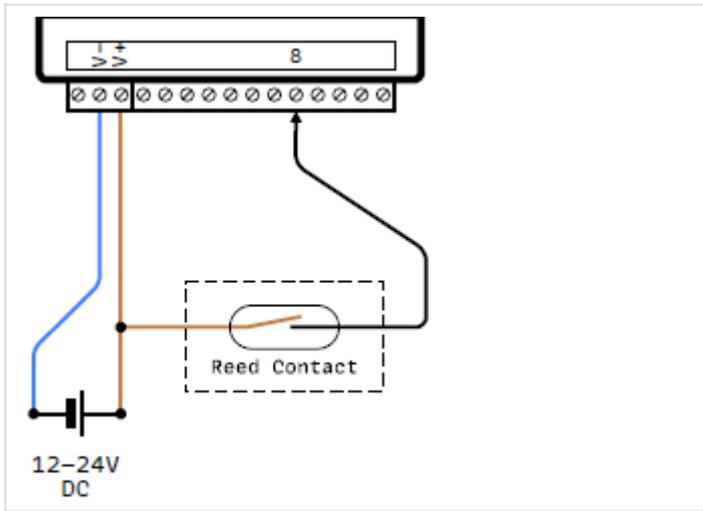
Typischer Anschluss eines Zählwerks, beispielhaft mit einfachem Reedkontakt, an CH8.
