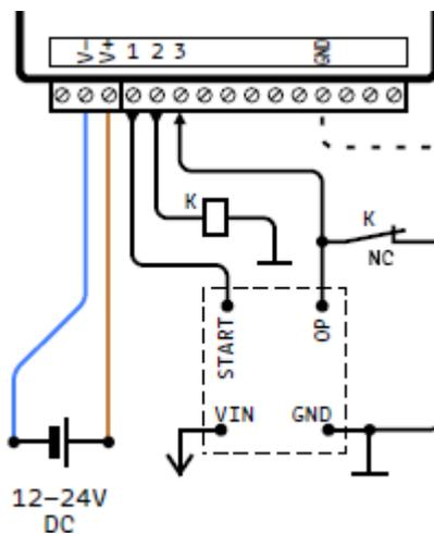
Beispiel für die Anpassung zur Ansteuerung einer NC Schaltung an einem aktiven, den Betriebszustand ausgebenden Anschluss.
