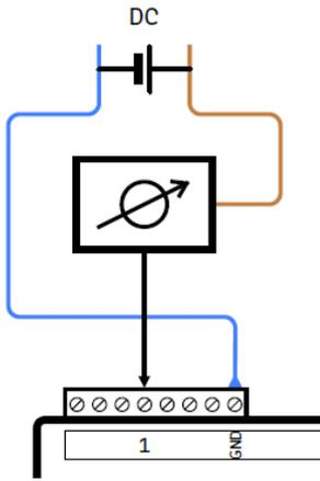
Typischer Aufbau für den Anschluss eines analogen Sensors (AIN Feld ist zu benutzen) bzw. analogen Aktuators (AOUT Feld ist zu benutzen) in Reihe.
