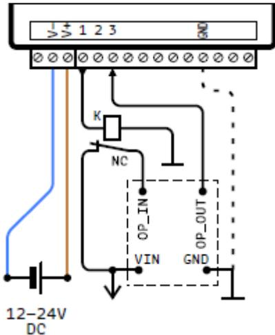
Beispiel für die Anpassung der Steuerung an Dauersignal (aktiv low) für den Betrieb mittels NC Schaltung an CH1.
