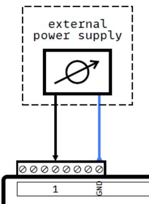
Typischer Aufbau für den Anschluss eines analogen Sensors (AIN Feld ist zu benutzen) bzw. analogen Aktuators (AOUT Feld ist zu benutzen) mit separater Stromversorgung.
