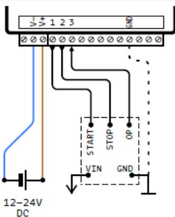
Typischer Anschluss für eine Steuerung mittels Pulssignal (aktiv high, Dauer konfigurierbar) für Start (CH1) und Stopp (CH2).
