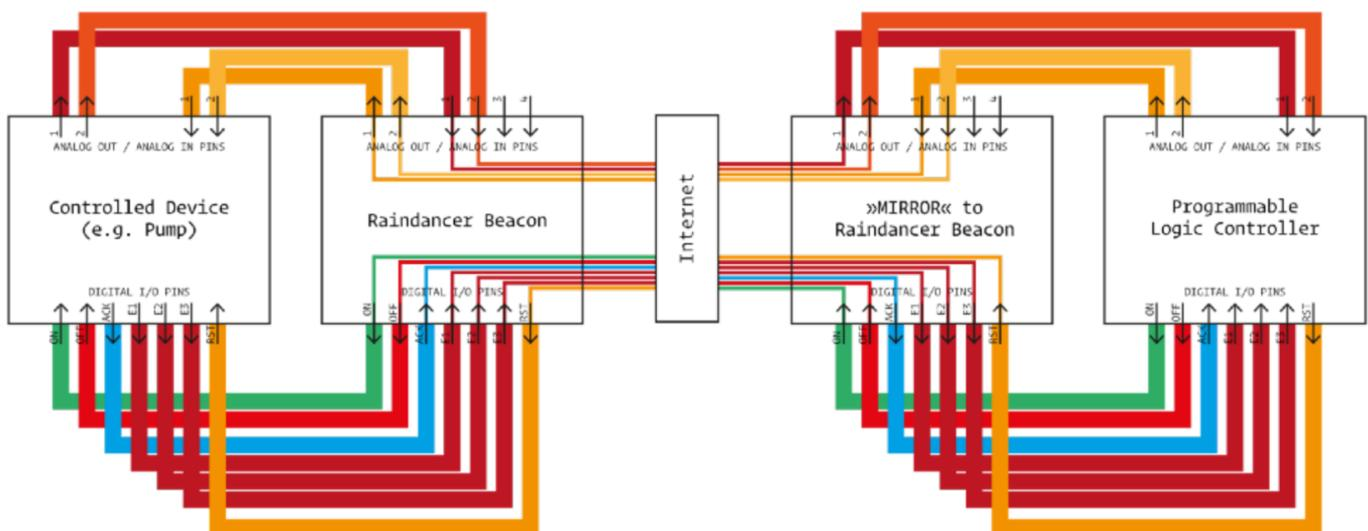
Hinweis: Ein als „Spiegelbild“ (i.d.Abb. »Mirror« bezeichnet) eingerichteter Beacon muss mit einer angepassten Konfiguration ausgeliefert werden.
