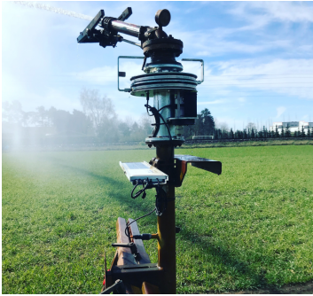
Die Montage einer Sektorverstellung auf einem Regnerwagen.
