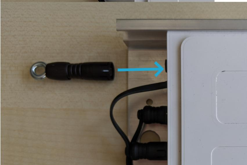
Warten Sie einige Sekunden und ziehen den Stecker wieder ab. Daraufhin wird das Gerät neu gestartet und die Verbindung sollte innerhalb weniger Minuten wiederhergestellt werden.
