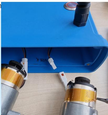
4. Nehmen Sie die neue Bodenplatte und richten Sie die Platte so aus, **dass die Kabel innerhalb der Box auf derselben Seite verlaufen wie die Kabel an den Motoren** und verbinden Sie die Steckverbindungen.
