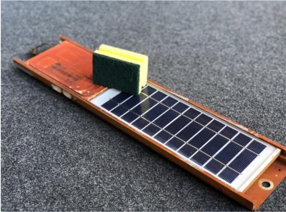
Ist das Solarmodul verschmutzt, können Sie eine Reinigung mit einem Glaskeramik-Reiniger wie er üblicherweise für Cerankochfelder verwendet wird vornehmen. Ein Putzschwamm bei Verwendung der „harten Putzseite“ eignet sich hier bestens!
